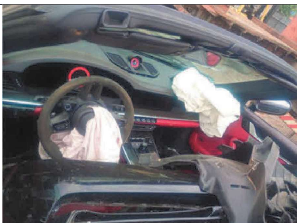
Foto 3 - Painel interno com airbags deflagrados/danificados
