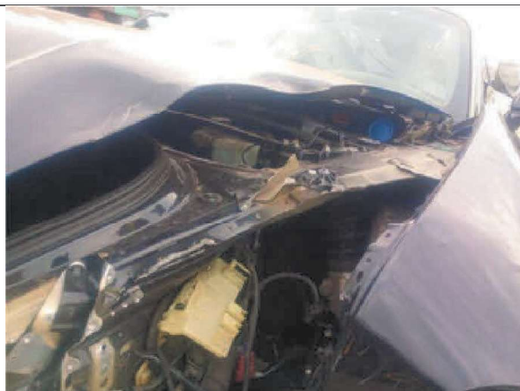
Foto 8 - Torre esquerda com avarias
